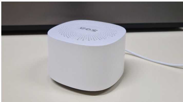
Figura 1. Dispositivo sensor de CO 2 e temperatura dispoñible no compartimento de eficiencia enerxética de A Caixa Sostible.
